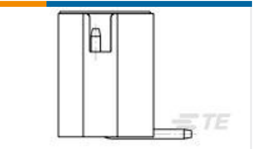
TE 系列/零件编号1775470-7 HPI CONN., 2.0MM, V/T, SMT, 7P, 80U"
