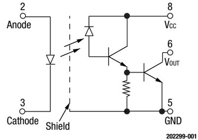
**Figure 1. OLH5700/5701 Block Diagram**
