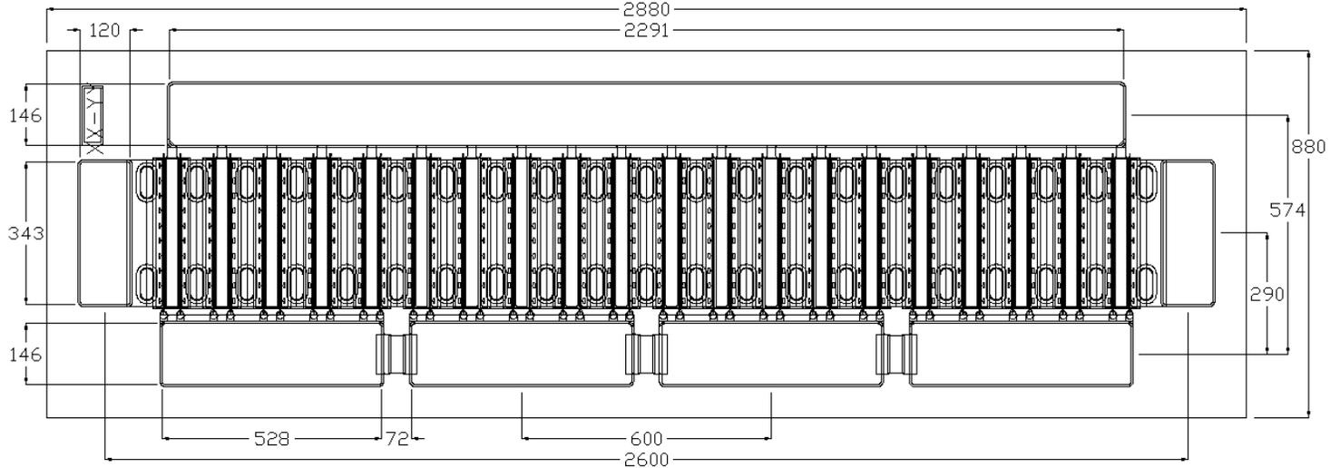
Overall die size 2880 x 880 (+0/-50) microns, die thickness 100 (+/- 10) microns.
