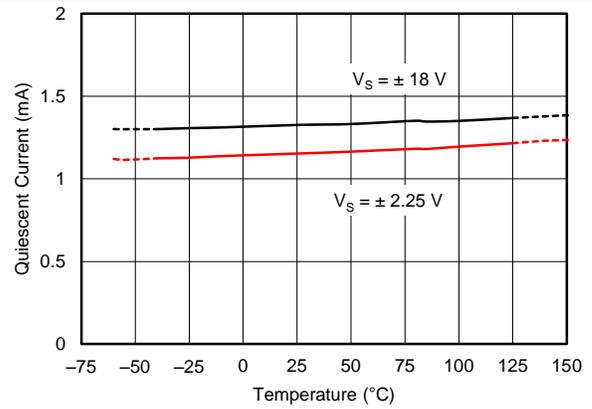
图 22. 静态电流与温度间的关系
