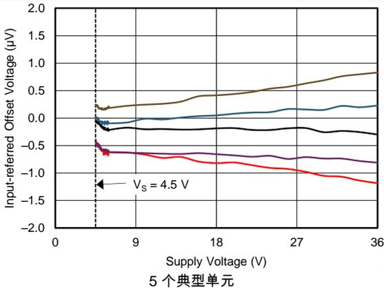
图 7. 失调电压与电源电压间的关系
