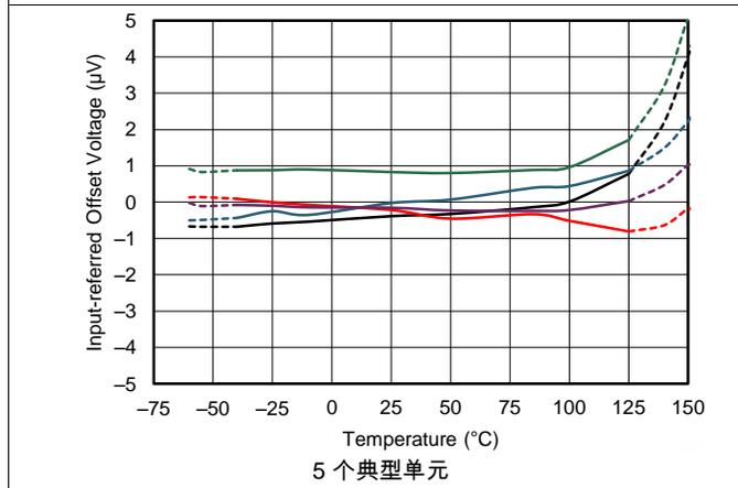
图 5. 失调电压与温度间的关系
