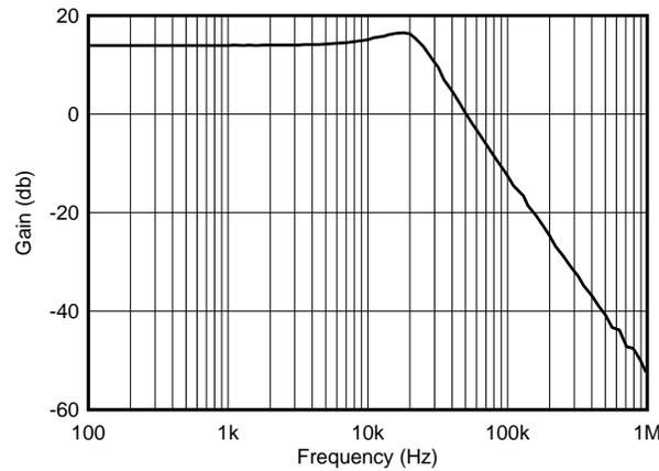
图 45. OPAx189 二阶 25kHz 切比雪夫低通滤波器
