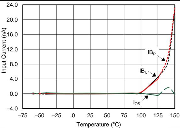
图 11. 输入偏置电流和失调电流与温度间的关系
