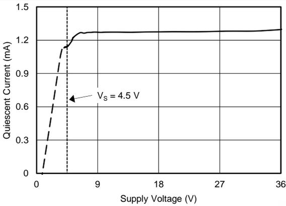
图 21. 静态电流与电源电压间的关系
