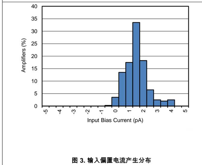
图 3. 输入偏置电流产生分布
