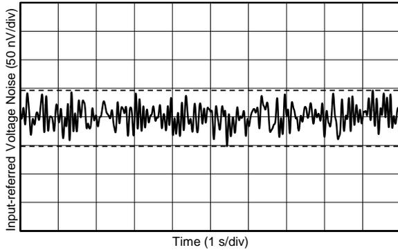
图 17. 0.1Hz 至 10Hz 电压噪声
