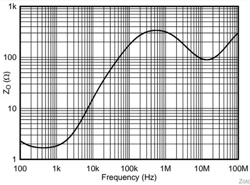
图 25. 开环输出阻抗与频率间的关系
