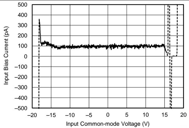
图 10. 输入偏置电流与共模电压间的关系
