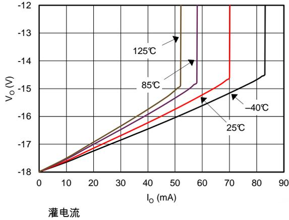
图 13. 输出电压摆幅与输出电流间的关系
