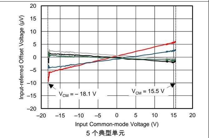
图 6. 失调电压与共模电压间的关系
