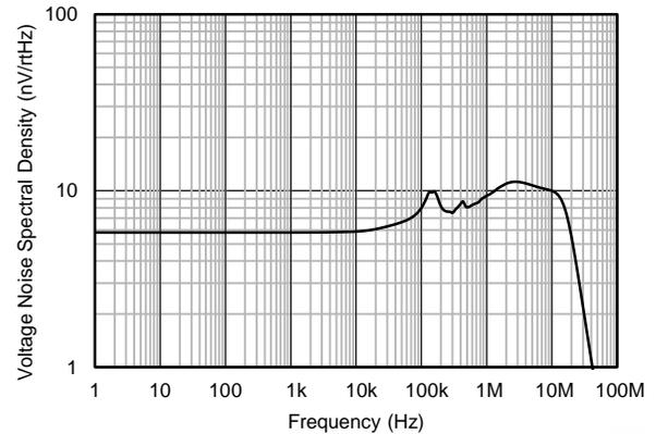
图 18. 输入电压噪声频谱密度与频率间的关系
