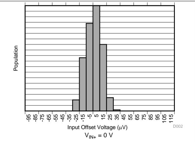
图 2. Input Offset Voltage Production Distribution A2
