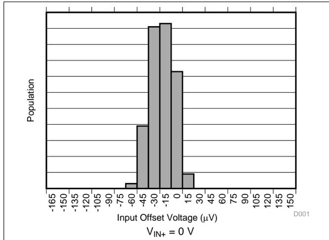
图 1. Input Offset Voltage Production Distribution A1
