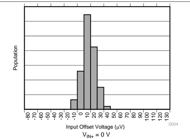
图 4. Input Offset Voltage Production Distribution A4
