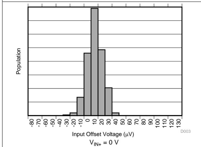
图 3. Input Offset Voltage Production Distribution A3
