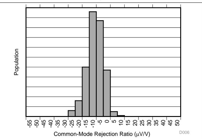
图 6. Common-Mode Rejection Production Distribution A1
