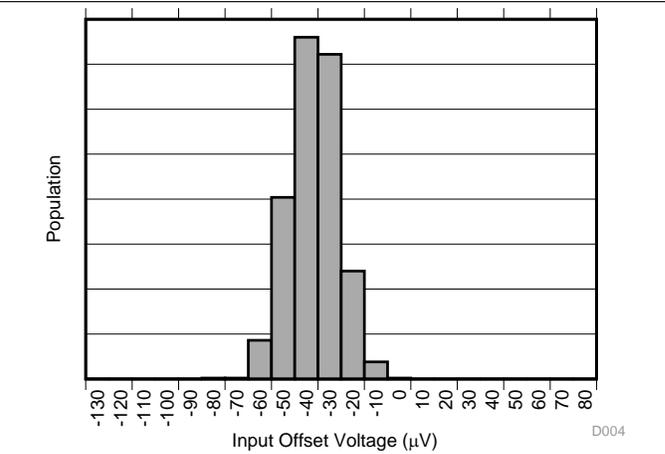
图 4. Input Offset Voltage Production Distribution A4
