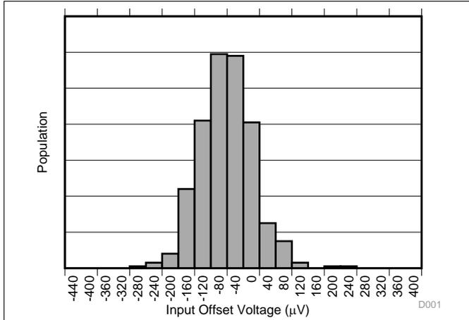
图 1. Input Offset Voltage Production Distribution A1
