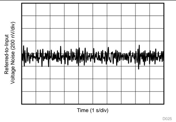
图 30. 0.1-Hz to 10-Hz Voltage Noise (Referred-to-Input)
