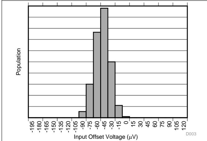
图 3. Input Offset Voltage Production Distribution A3
