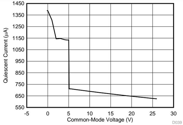
图 28.  $I_Q$  vs Common-Mode Voltage (INA4181)
