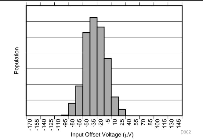
图 2. Input Offset Voltage Production Distribution A2
