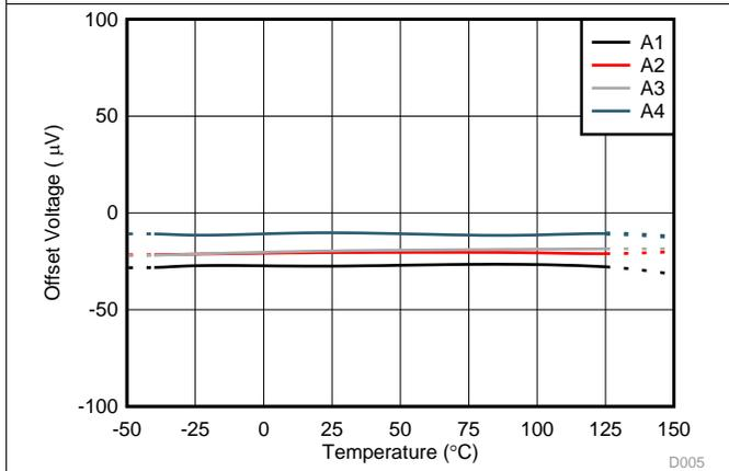
图 5. Offset Voltage vs Temperature
