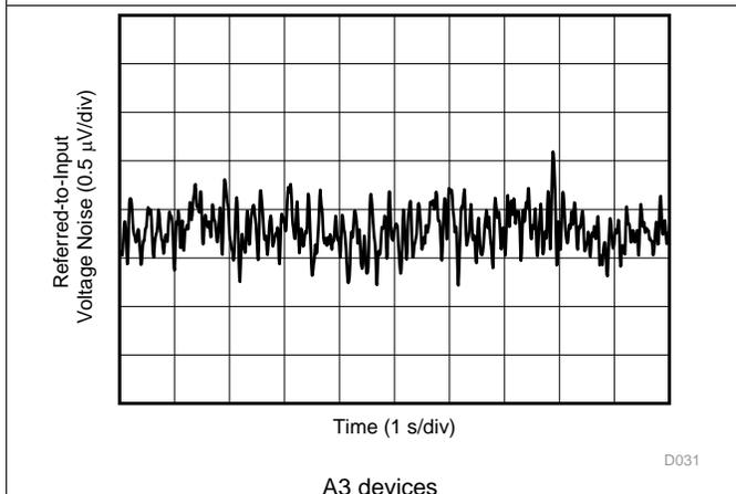
图 21. 0.1-Hz to 10-Hz Voltage Noise (Referred-To-Input)
