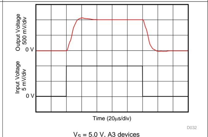
图 22. Step Response (10-mV<sub>PP</sub> Input Step)
