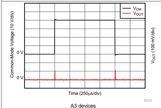
图 23. Common-Mode Voltage Transient Response
