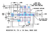
NOTES: 1. TRACE WIDTH IS SHOWN FOR ROGERS R04350B WITH DIELECTRIC THICKNESS 0.030" ± 0.002"; COPPER: 1/2 0Z. EACH SIDE. FOR OTHER MATERIALS TRACE WIDTH MAY NEED TO BE MODIFIED. 2. BOTTOM SIDE OF THE PCB IS CONTINUOUS GROUND PLANE.
